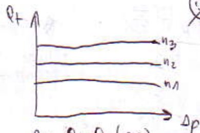
Rys. Q_t = Q_t(\Delta p) . Charakterystyka przepływu.
