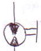
Rys. Silnik hydrauliczny • dwa kierunki zasilania • stała mocność
