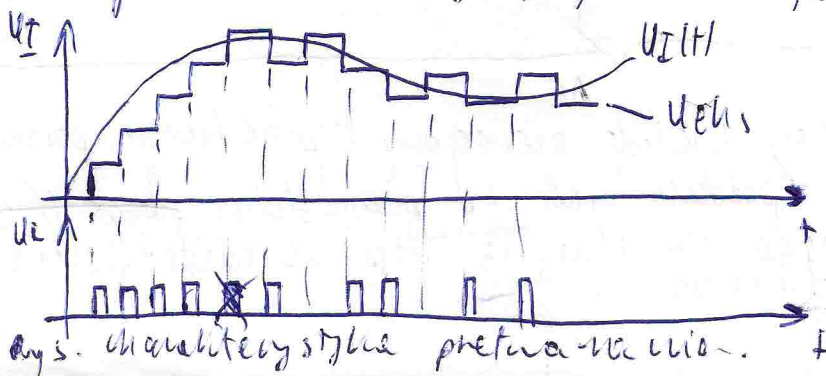
Rys. Metoda przetwarzania A/C wykorzystująca moduł Delta.
